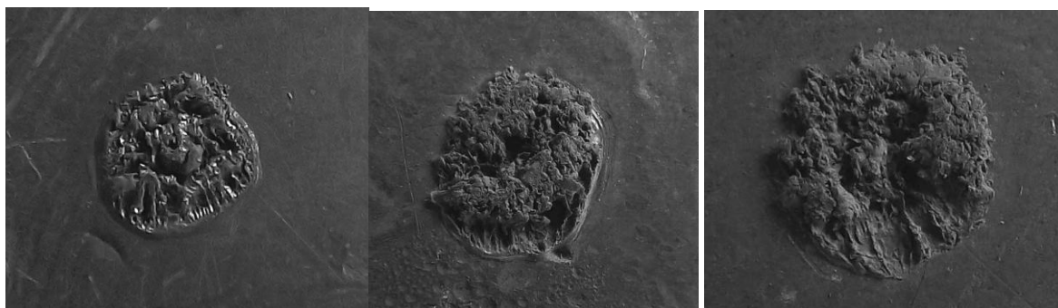
Рис. 1. Фотографии кратеров, полученных при воздействии на свинцовый образец, расположенный в воде, лазерных импульсов с энергией 10 Дж (а), 20 Дж (б), 40 Дж (в)
