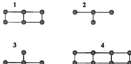
соответствует типовым неявным двухслойным схемам для нестационарного уравнения теплопроводности?
