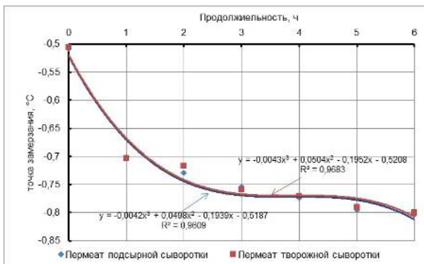
Рисунок 3 - Динамика точки заморозания контрольных образцов в течение ферментативной обработки с применением ферментного препарата «Биолактаза Л20»
