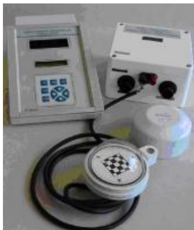
Рис. 8. Пиранометр Пеленг СФ-06
