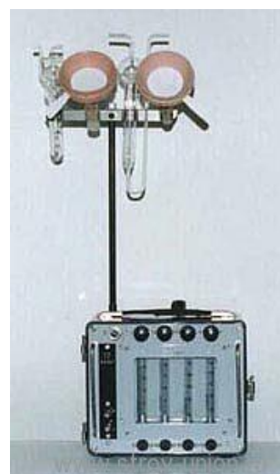
Рис. 11. Отбор проб воздуха с помощью ФВУ (электроаспиратора)
