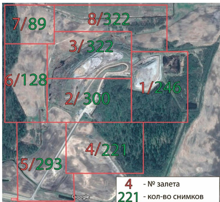
Рисунок 1 – Схема выполнения аэрофотосъемки
