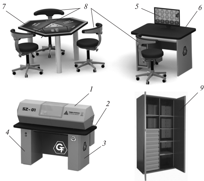
Рис. 1.9. Общий вид испытательного центра SZ-01: 1 – установка испытательная; 2 – стол специальный; 3 – информационно-управляющая система; 4 – электросиловая система; 5 – персональный компьютер; 6 – стол для ПК; 7 – стол для текущей документации; 8 – стулья специальные; 9 – шкаф инструментальный
