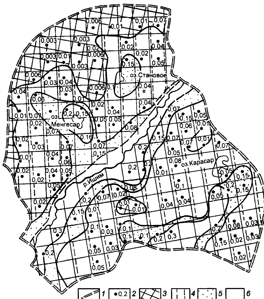
Рис. 13.1. Распределение величин инфильтрационного питания на территории Приишимской равнины (южная часть Западно-Сибирской низменности): 1 — границы расчетного участка; 2 — расчетный блок, цифра — величина
