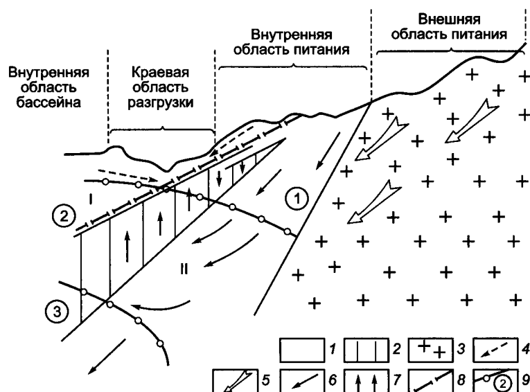
Рис. 10.4. Принципиальная схема формирования потоков подземных вод в краевой части артезианского бассейна платформенного типа: 1 — системы межпластовых горизонтов I и II гидрогеологических этажей бассейна; 2 — слабопроницаемые разделяющие толщи; 3 — породы обрамления и фундамента; 4 — направления движения подземных вод I этажа; 5 — трещинных вод обрамления; 6 — II гидрогеологического этажа; 7 — направления затрудненной субвертикальной фильтрации через слабопроницаемые породы; 8 — границы и номера гидрогеологических этажей; 9 — границы и номера гидродинамических зон
