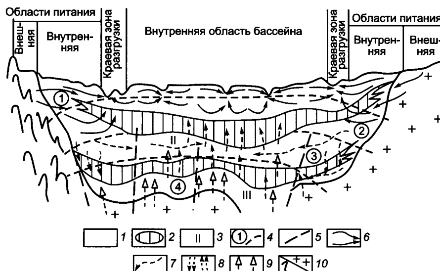
Рис. 10.9. Принципиальная гидродинамическая схема артезианского бассейна платформенного типа: 1 — слоистые системы водоносных горизонтов (комплексов) трех гидрогеологических этажей бассейна; 2 — региональные слабопроницаемые толщи; 3 — номера гидрогеологических этажей; 4 — границы и номера гидродинамических зон; 5 — зоны тектонических нарушений; 6 — система "местных" и 7 — региональных потоков подземных вод; 8 — субвертикальная фильтрация через слабопроницаемые породы; 9 — "внутренние" источники питания подземных вод (элизионные процессы, дегидратация, приток глубинных флюидов); 10 — породы обрмления и фундамента
