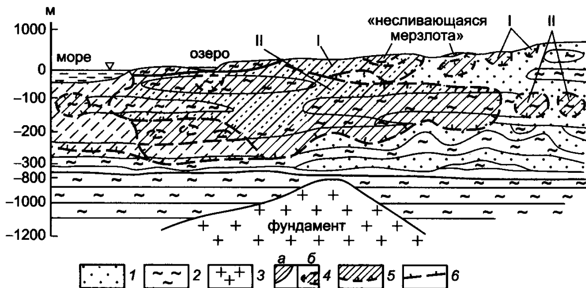
Рис. 12.3. Строение криолитозоны платформенных областей (по Н.Н. Романовскому, 1983): I — плейстоценовые , II — верхнеголоценовые мерзлые толщи ; 1 — преимущественно песчаные водоносные породы ; 2 — глинистые слабопроницаемые ; 3 — породы фундамента ; 4 — слой сезонного промерзания (а), многолетнемерзлые породы (ММП) и граница их распространения (б) ; 5 — охлажденные породы с криогалинными водами и граница их
