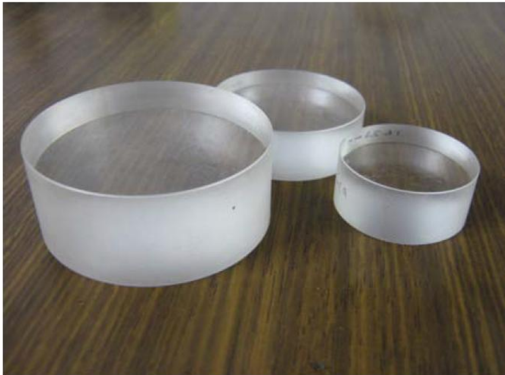
Рисунок – «Эталоны» для проверки и калибровки измерителей теплопроводности.
