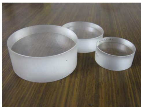
Рисунок – Эталоны с разной теплопроводностью для проверки и калибровки измерителей теплопроводности.
