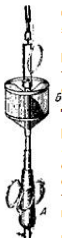
Рисунок 14 – Схема устройства грунтовой трубки Пито. А – грунтовая трубка, Б – стабилизатор.
