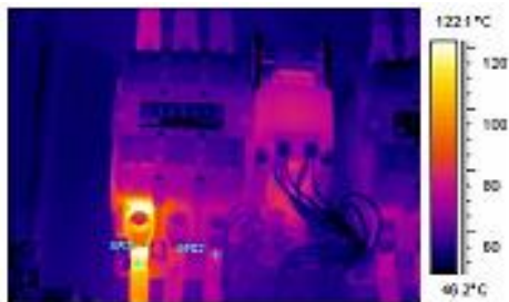
Рис. 2.7. ИК-изображение контактов в системе электрооборудования
