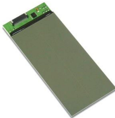
Рис. 1. Внешний вид матрицы RadEye™100
