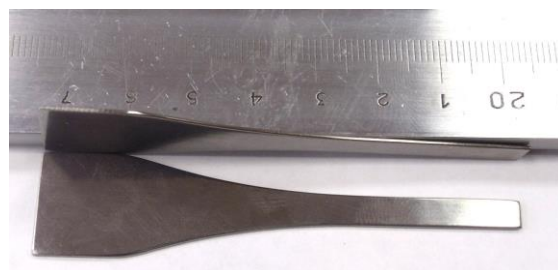
Рис. 1. Внешний вид усталостных образцов с острыми кромками из сплава BT18U
