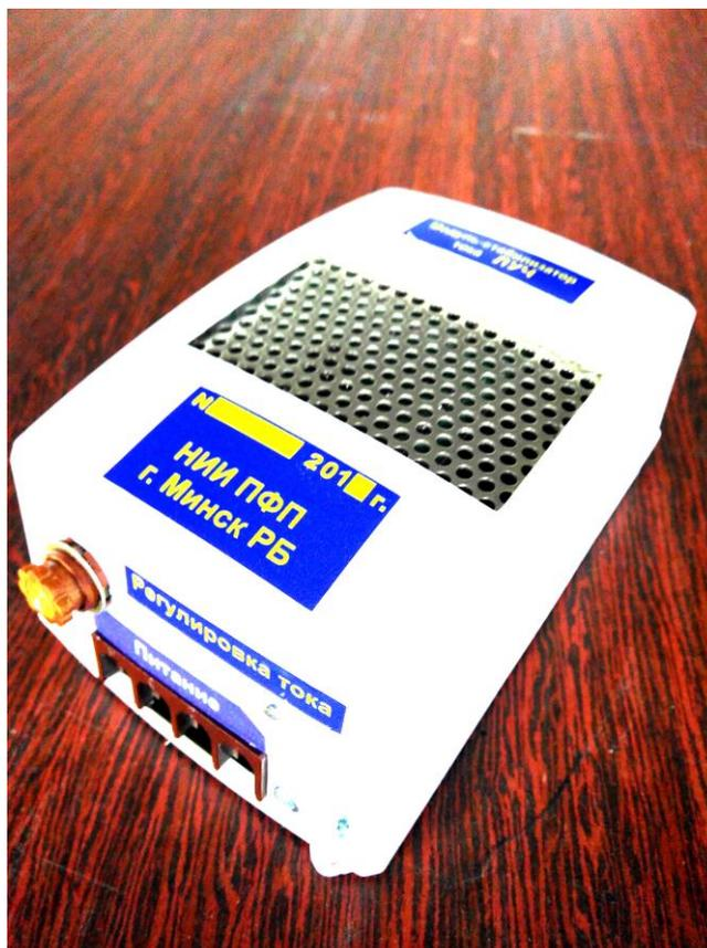
Рисунок 1 – Источник электропитания высоковольтных дуговых ламп мощностью 150 Вт
