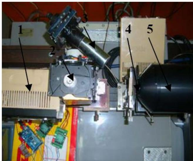
1 – рентгеновская трубка, 2 – сканирующее устройство, 3 – сцинтилляционный детектор,
