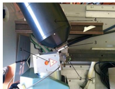
Рисунок 2 – Фотография стенда (вид сверху): 1 – рентгеновская трубка; 2 – объект; 3 – пинхол камера; 4 – рентгеновская ПЗС-камера
