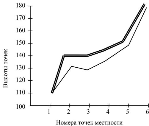
*Рис. 23.* График высот, вычисленных (A) и определенных по топокарте (A')
