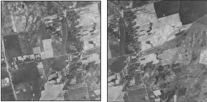
Рис. 19. Стереопара снимков
