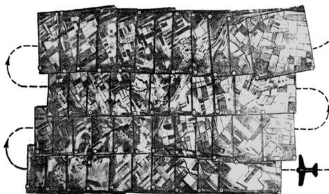
Рис. 21. Схема площадной аэрофотосъемки
