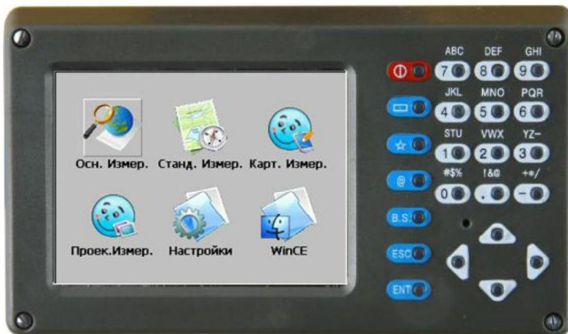
Рис. 1.28. Клавиатура и дисплей тахеометра South NTS-372R
