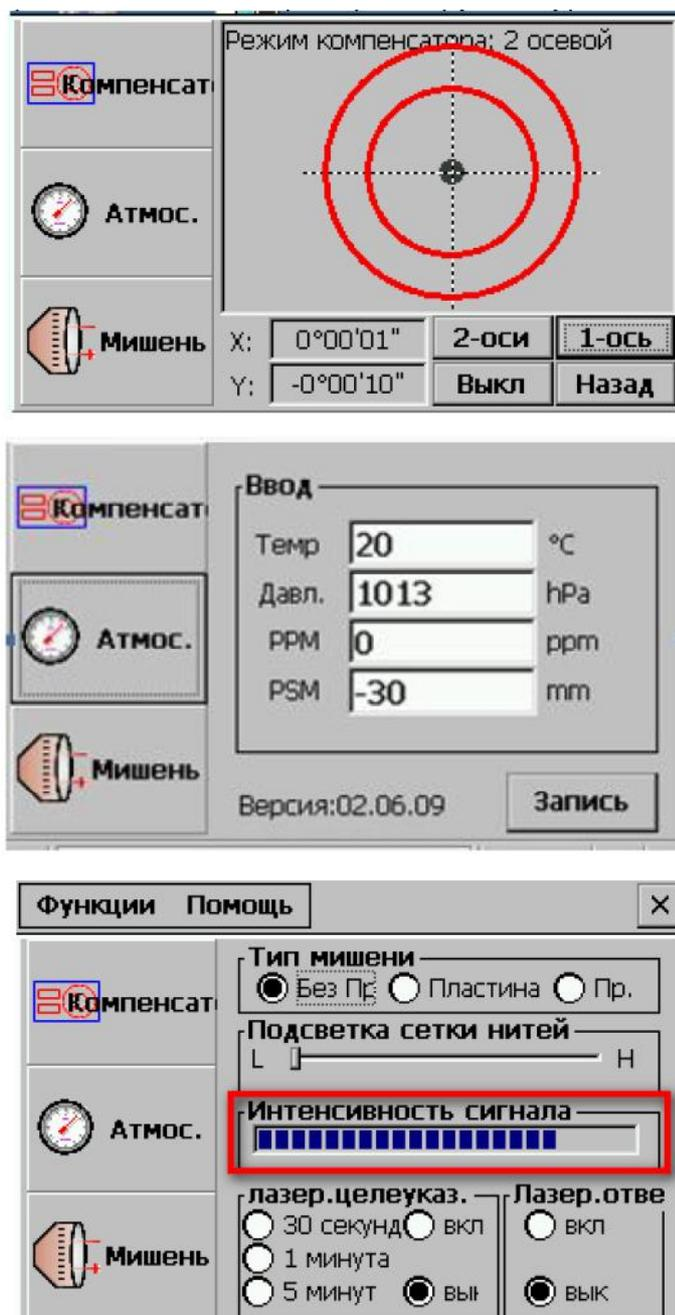
Рис. 1.30. Меню предварительных настроек тахеометра South NTS-372R
