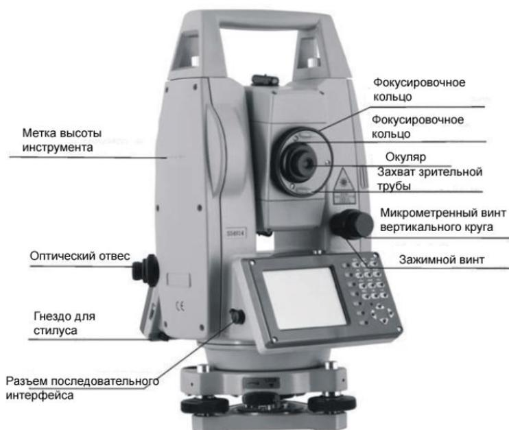
Рис. 1.26. Основные конструктивные элементы тахеометра South NTS-372R
