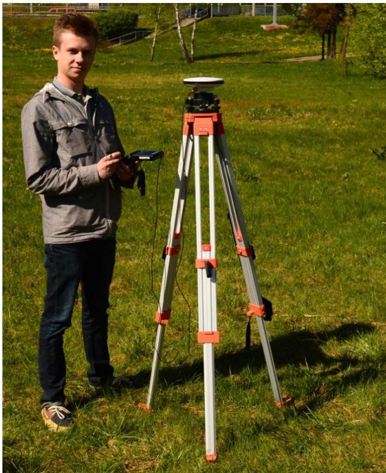
Рис. 1.10. Пример установки GPS-системы на одном из концов базисной линии
