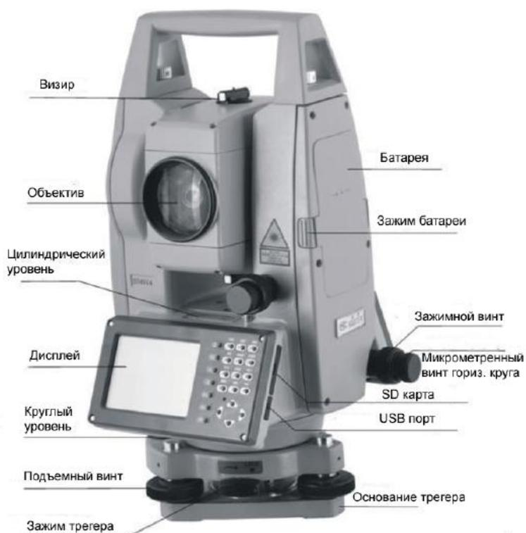
Рис. 1.27. Основные конструктивные элементы тахеометра South NTS-372R
