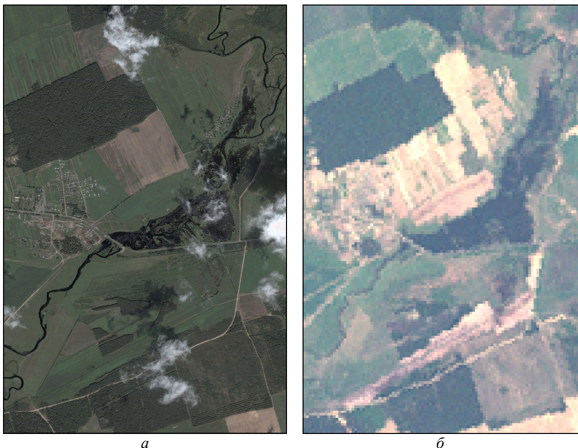
Рис. 2.1. Космические снимки с разным пространственным разрешением: а – размер пиксела 1 м (QuickBird); б – размер пиксела 30 м (Landsat-7 ETM+; комбинация красной, зеленой и синей зон видимого диапазона)
