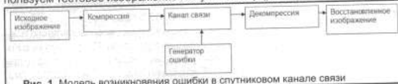
Рис. 1. Модель возникновения ошибки в спутниковом канале связи
