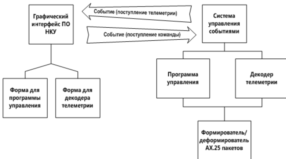
Рис.3. Структура ПО промышленного компьютера
