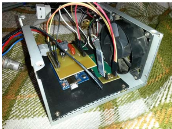
Рисунок 3. – Фотография устройства системы автоматизации «Умный дом» без корпуса
