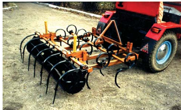
Рис. 8. Мини-трактор с почвообрабатывающим агрегатом
