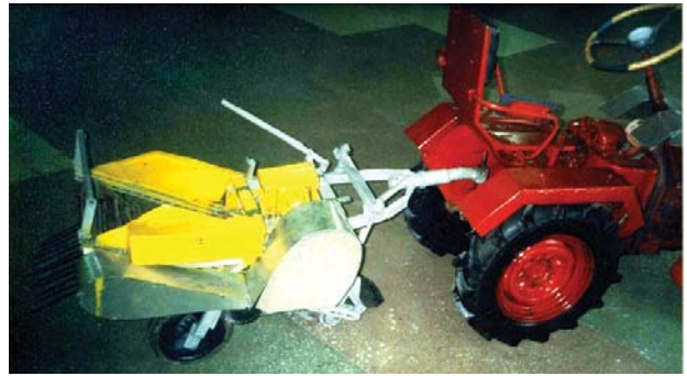
Рис. 2. Мини-трактор с картофелекопателем
