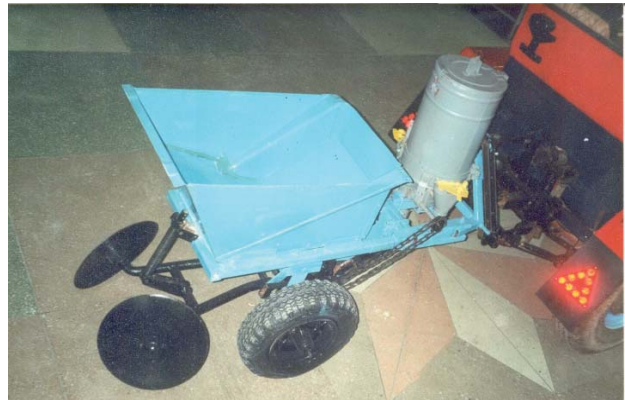
Рис. 4. Мини-трактор с роторной картофелесажалкой
