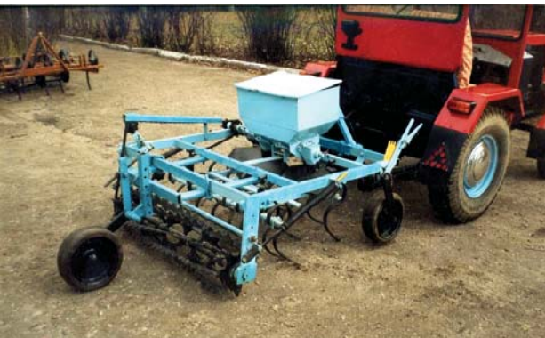
Рис. 7. Мини-трактор с агрегатом для внесения удобрений
