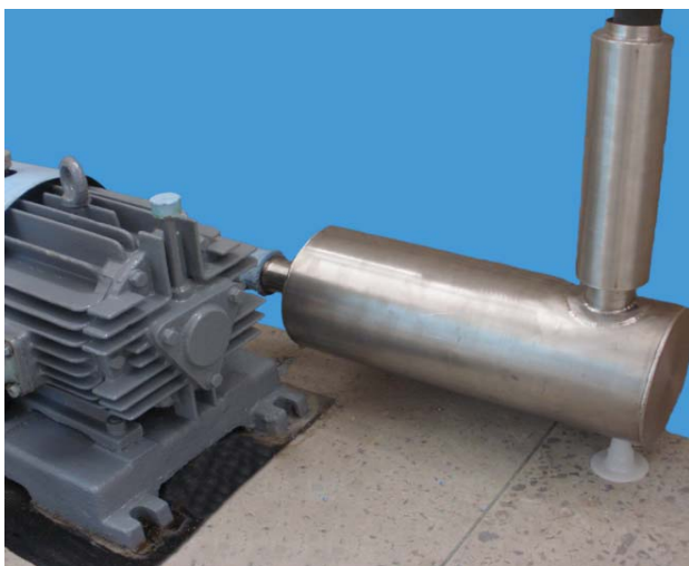
Рис. 9. Глушитель шума вакуумного насоса
