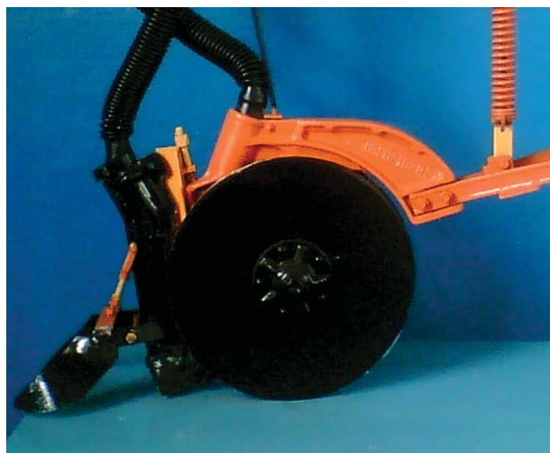
Рис. 10. Комбинированный двухдисковый сошник
