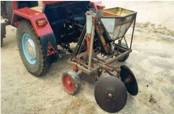
Рис. 3. Мини-трактор с элеваторной картофелесажалкой
