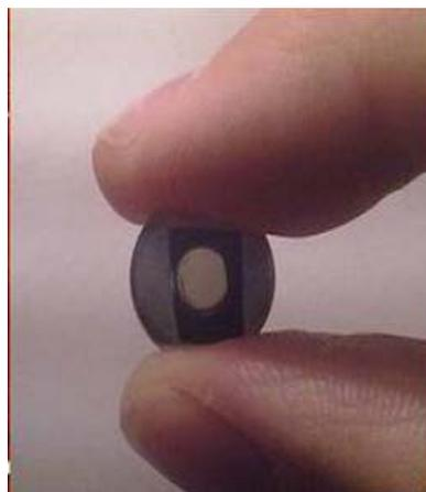
**Рисунок 2.** – Оптическое изображение гибридной пленки ОУНТ/ $WS_2$ -МНТ
