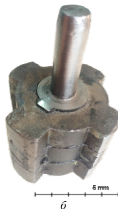
Рисунок 1. – Микрочастица с наномодифицированной поверхностью (а) и ротор диаметром 70 мм, изготовленный из композиционного магнито-мягкого материала (б)
