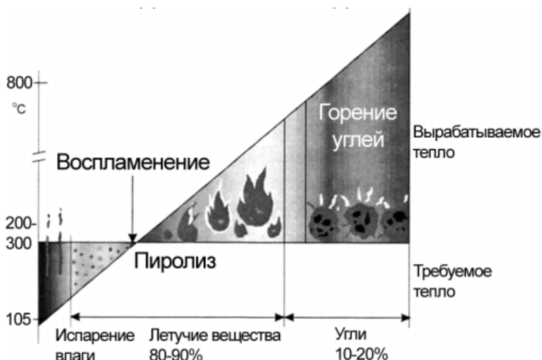
Рис. 1.1. Стадии сжигания твердого топлива
