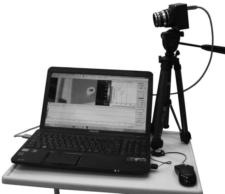
Общий вид высокотемпературного трехзонального тепловизора ИТ-3СМ
