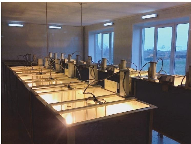
Рис. 2. Цех по производству суспензии хлореллы.
