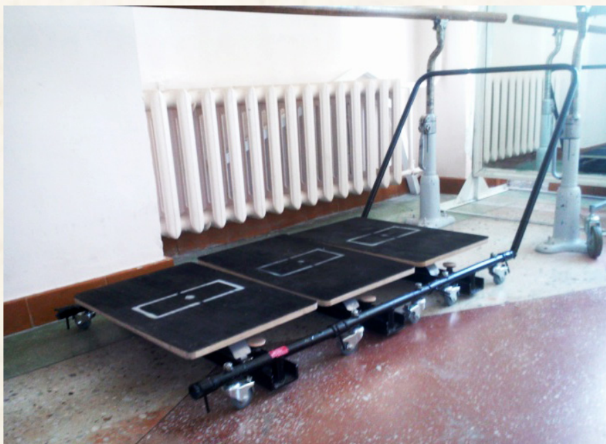
Рис. 2. Тренажер для реабилитации инвалидов с ампутированной нижней конечностью
