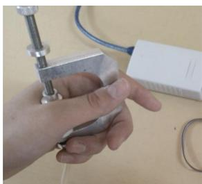
Рисунок 1 – Эдемометр
