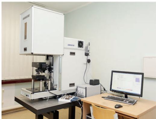
Спектрально-аналитический комплекс на основе сканирующего конфокального микроскопа Nanofinder. 2011 г.
