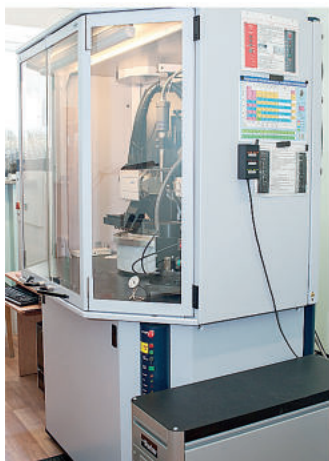
Автоматический рентгеновский дифрактометр SMART APEX II CCD. 2010 г.
