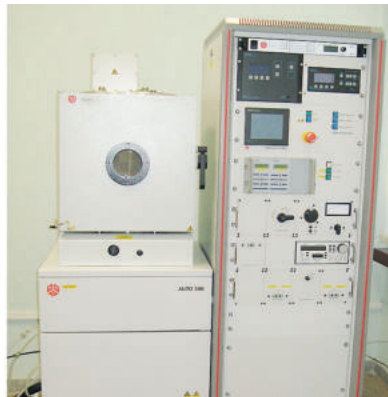
Автоматизированная вакуумная установка для ионно-плазменного нанесения нанокompозитных покрытий и тонких пленок Auto 500. 2013 г.
