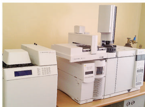
Газовый хроматограф Agilent 7890A с двумя детекторами. 2010 г.
