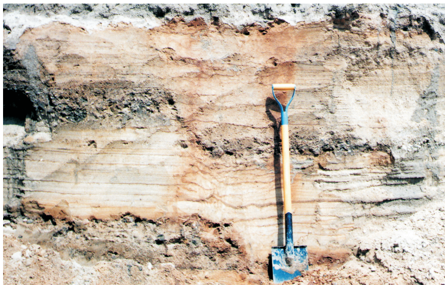
Рис. 14. Слои песка, алевритов и песчано-гравийно-галечного материала кама, деформированные глициокарстовыми просадками
