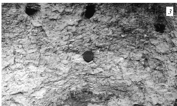
Рис. 10. Отложения основной морены. Текстуры: 1 — массивная; 2 — слоистая; 3 — плитчатая
