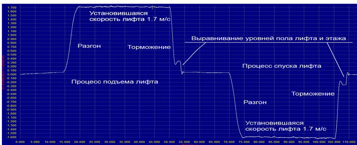
Рис. 5. График скорости (интеграл от ускорения)
