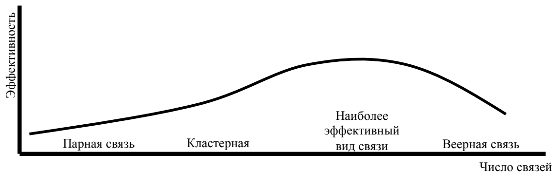
Рис. 1.6. Степень эффективности различных видов связей между системами при их объединении в суперсистему
