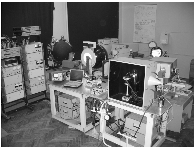
Рис. 3. Метрологический комплекс «Камелия-М», предназначенный для калибровки оптической аппаратуры
