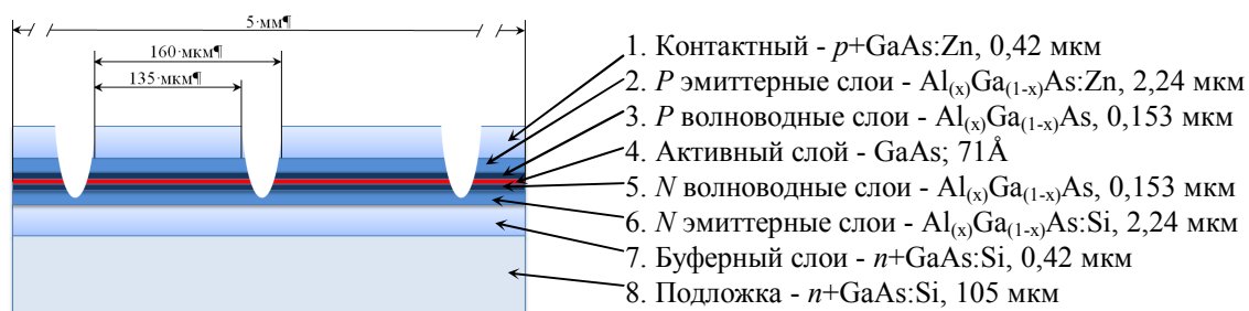
Рис. 1. Линейка лазерных диодов в МЛД
