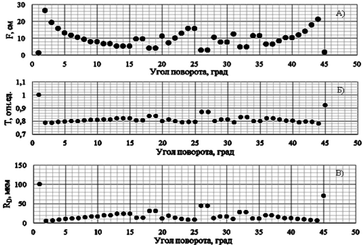
Рис. 2. Зависимость фокусного расстояния (А), пропускания (Б) и радиуса диафрагмы (В) от угла поворота 3D-линзы с кубической упаковкой микролинз .
