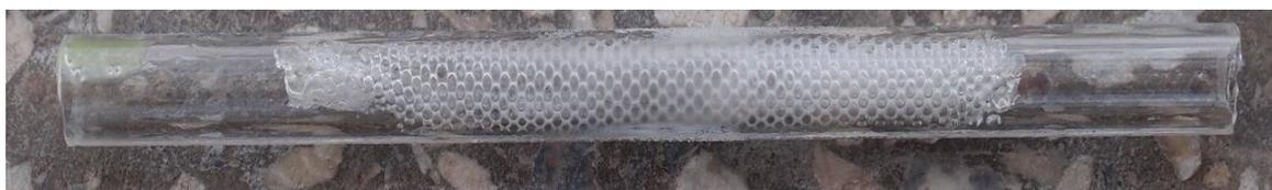
*Рис. 1.* Образец 3D-линзы с гексагональной структурой, полученной в СНИЛ кафедры физической электроники и нанотехнологий БГУ
