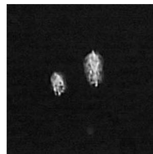
Рис. 1. Увеличенная фотография микродефекта в стекле
