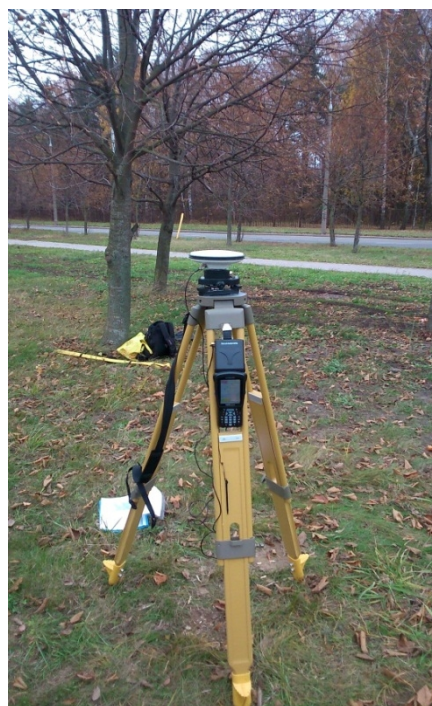
Рис. 1. Пример установки GPS-системы на одном из концов базисной линии
