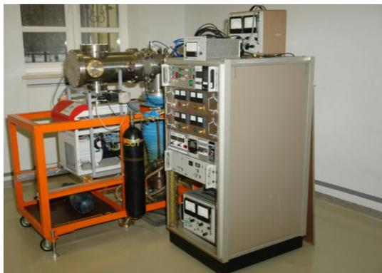
Рис. 1. Ускоритель газовых кластерных ионов.
