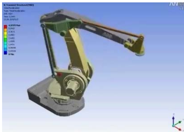
Рис. 3. Модель манипулятора M410-ib в среде ANSYS Workbench
