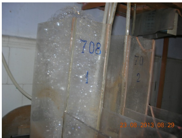
Рисунок 2. Высота столба пены (14–15 см) в опытном азротенке (слева) с 1-х по 60-е сутки проведения эксперимента по оценке биоразлагаемости концентрата Forafac® 1157N ( C_{\text{вх}} = 1 \text{ мг/л} по перфторПАВ, \text{ХПК}_{\text{вх}} = 10 \text{ мг/л} ; \Delta\text{ХПК}_{\text{вых}} = 0 )
