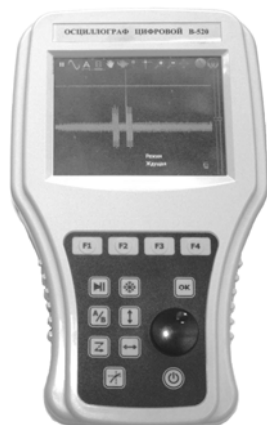
Рис. 1. Внешний вид цифрового осциллографа В-520
