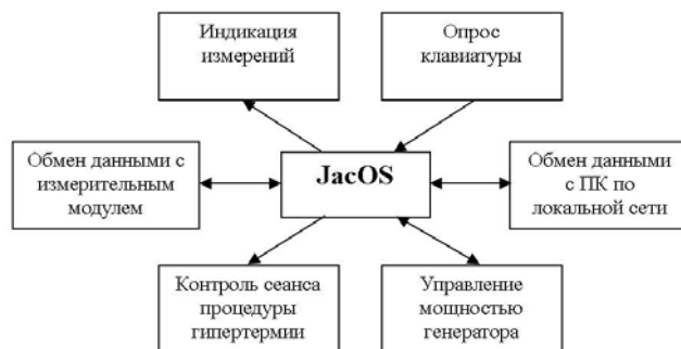
Рис. 4. Структура программного обеспечения управляющего контроллера
