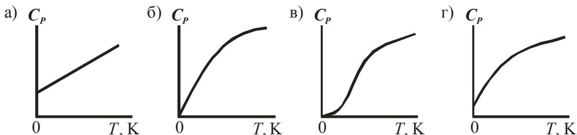
56. Для некоторой реакции изменение теплоемкости как функция температуры выражается следующим уравнением:  $\Delta C_P = \Delta a + \Delta bT + \Delta cT^2$ , где  $\Delta a$ ,  $\Delta b$  и  $\Delta c$  больше нуля. Как схематически зависит  $\Delta_r H$  от температуры?
