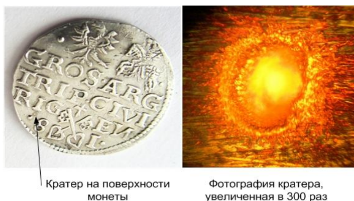
Рис.1. Фотография кратера на поверхности серебряной монеты после анализа, а также изображение этого же кратера, увеличенное в 300 раз
