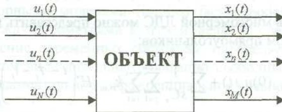
Рис. 8. Схема динамического объекта с N -мерным входом и с M -мерным выходом.
