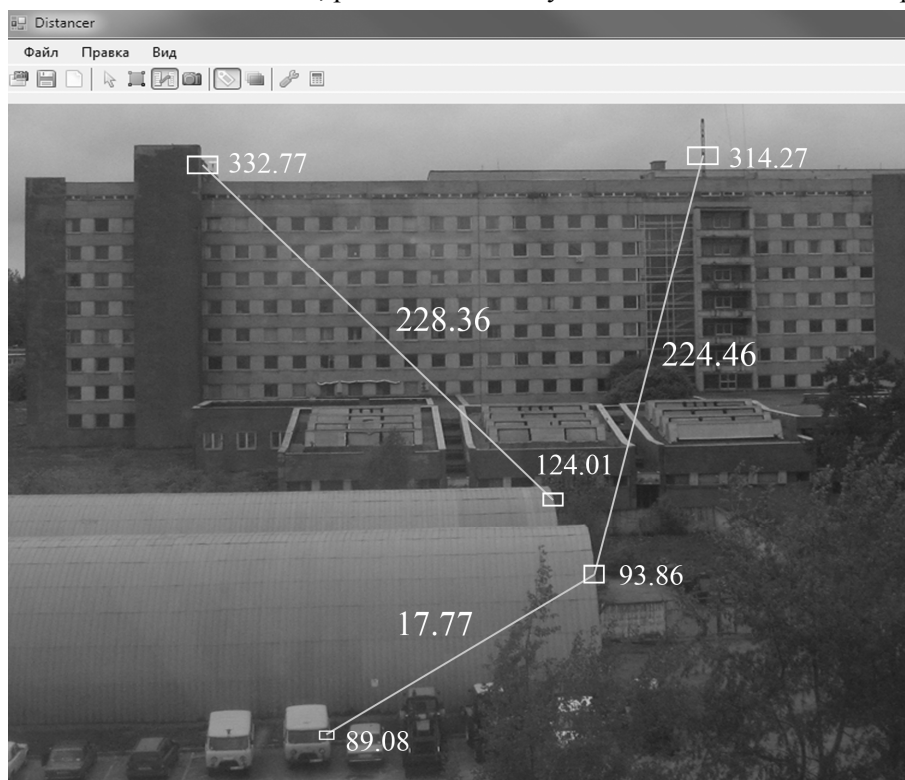
Рис. 3. Интерфейс измерительной системы и пример работы измерителя по цифровой фотографии учебного корпуса факультета радиофизики
