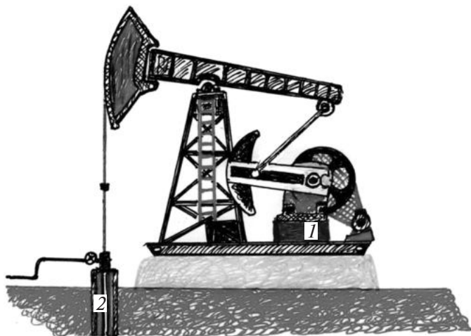
Рис. 4.6. Привод плунжерного насоса от станка-качалки: 1 – станок-качалка; 2 – устьевое оборудование скважины, ввод штанги к плунжерному насосу
