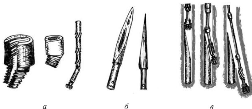
Рис. 7.8. Отклонители скважинные и процесс отклонения ствола скважин: а – отклоняющий переходник; б – отклоняющий клин; в – процесс отклонения ствола скважин клиновым отклонителем
