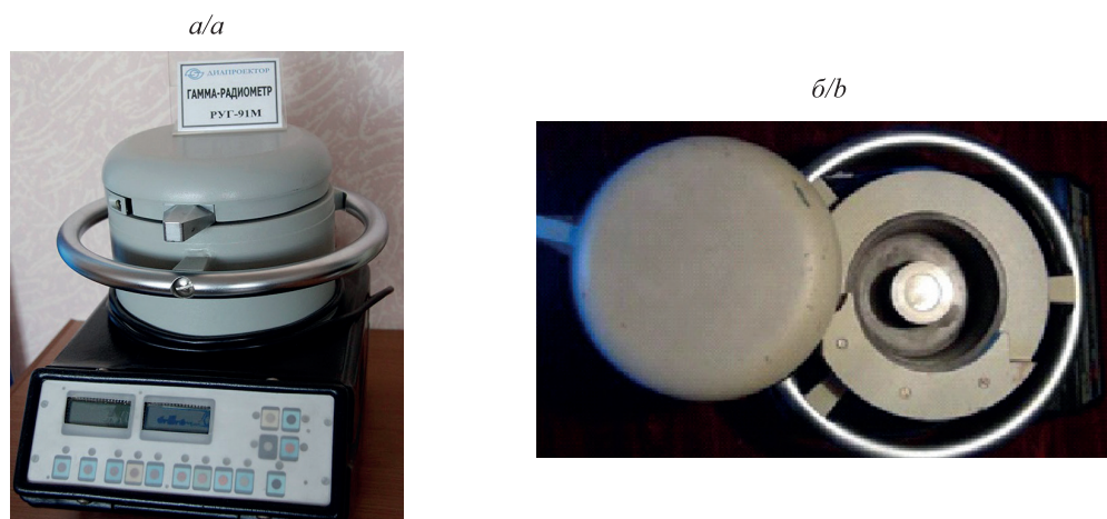
Рис. 2. Общий вид гамма-радиометра РУГ-91М «Адани» (а) и его внутренний вид при снятом сосуде Маринелли (б) Fig. 2. General view of the RUG-91M «Adani» gamma radiometer (a) and its internal view with the Marinelli vessel removed (b)
