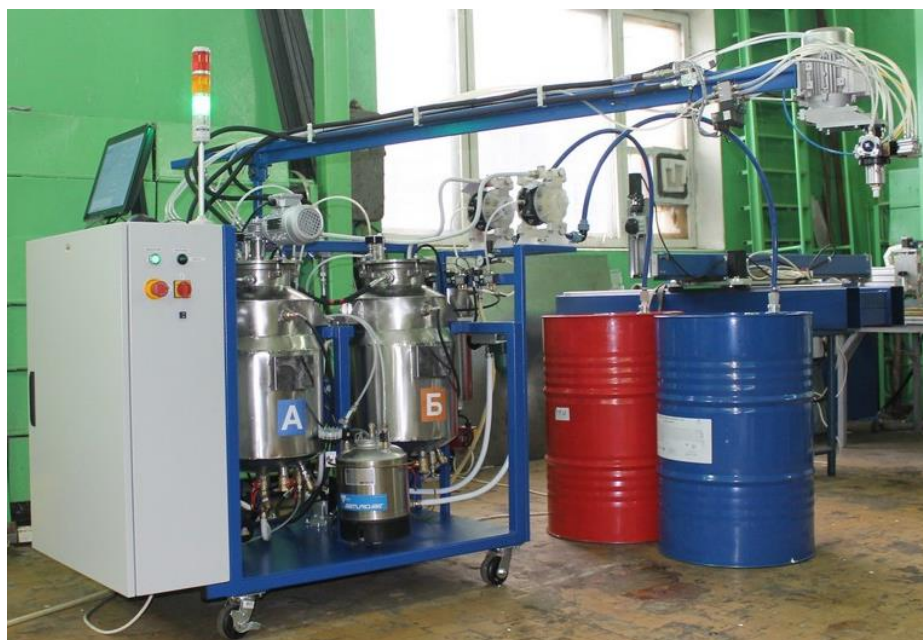
Рисунок 1 – Автоматизированное оборудование для непрерывного производства предизолированных труб из пенополиуретановых систем
