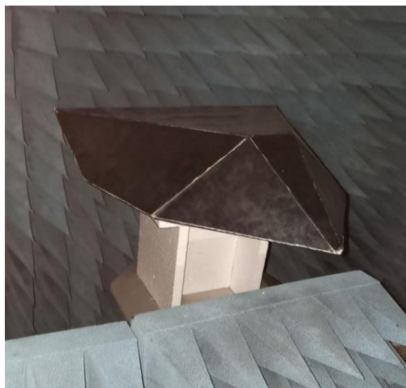
Рисунок 3 – Испытание «стелс» модели фюзеляжа в безэховой камере
